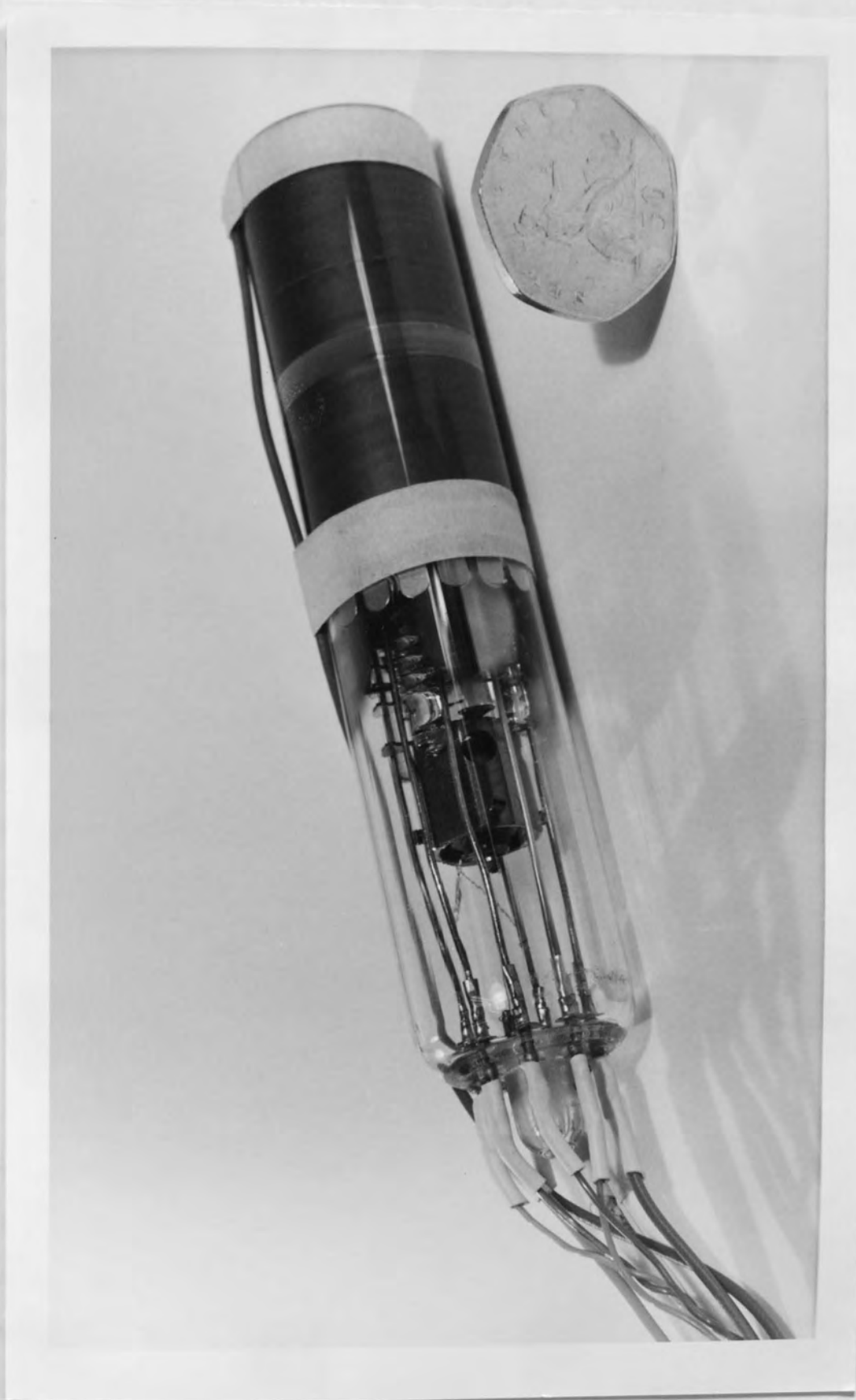
Fig. 4.60 Miniature field emission C R T.
